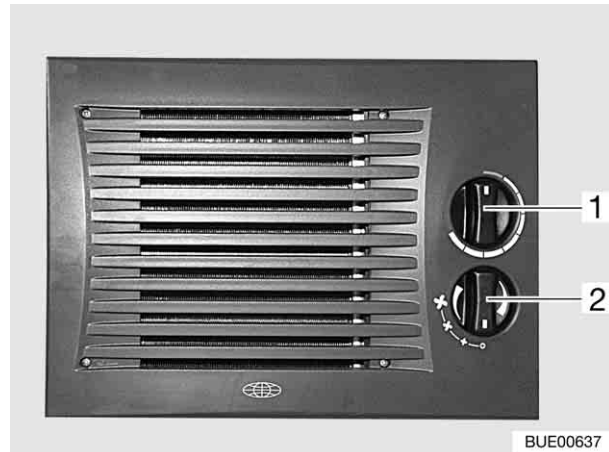
Fig. 121 Boutons de commande de l'échangeur de chaleur
