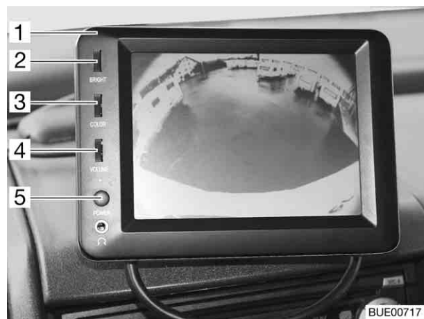
Fig. 10 Moniteur ACL pour caméra de marche arrière
