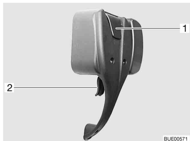
Fig. 17 Serrure de la porte cellule, à l'intérieur, verrouillée (variante 1)
